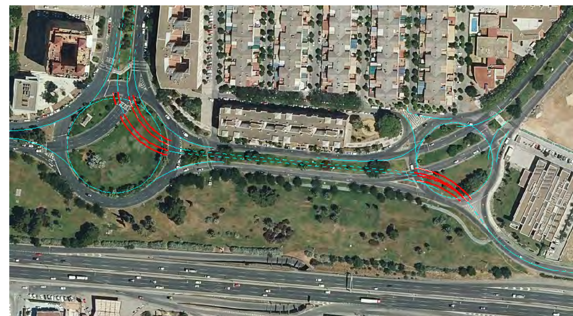
Imagen de las zonas de nuevo trazado para carriles de tranvibus en glorietas de la Av. del Deporte
