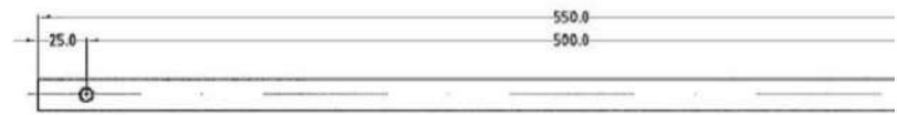
11 PLETINA DE APRIETE EN CRISTALES DE TECHO Cantidad: 4 piezas Material: acero inox AISI 304
