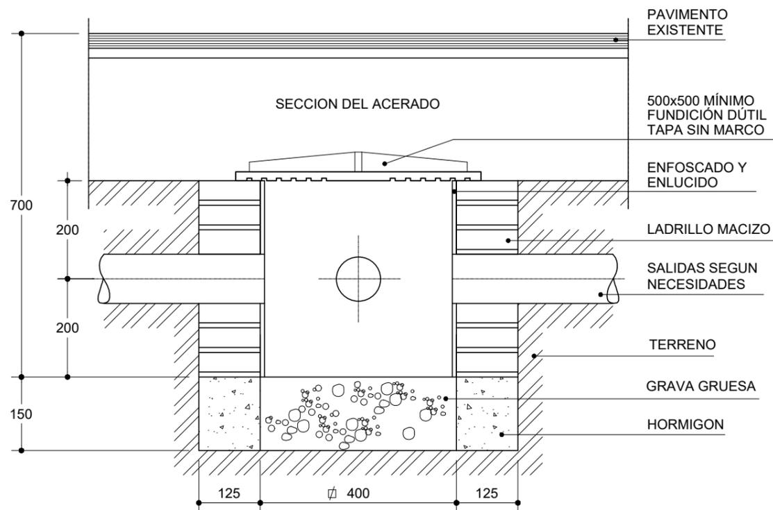
**TAPA Y MARCO EN FUNDICION DUCTIL PARA ARQUETA DE 450x450 mm.**
