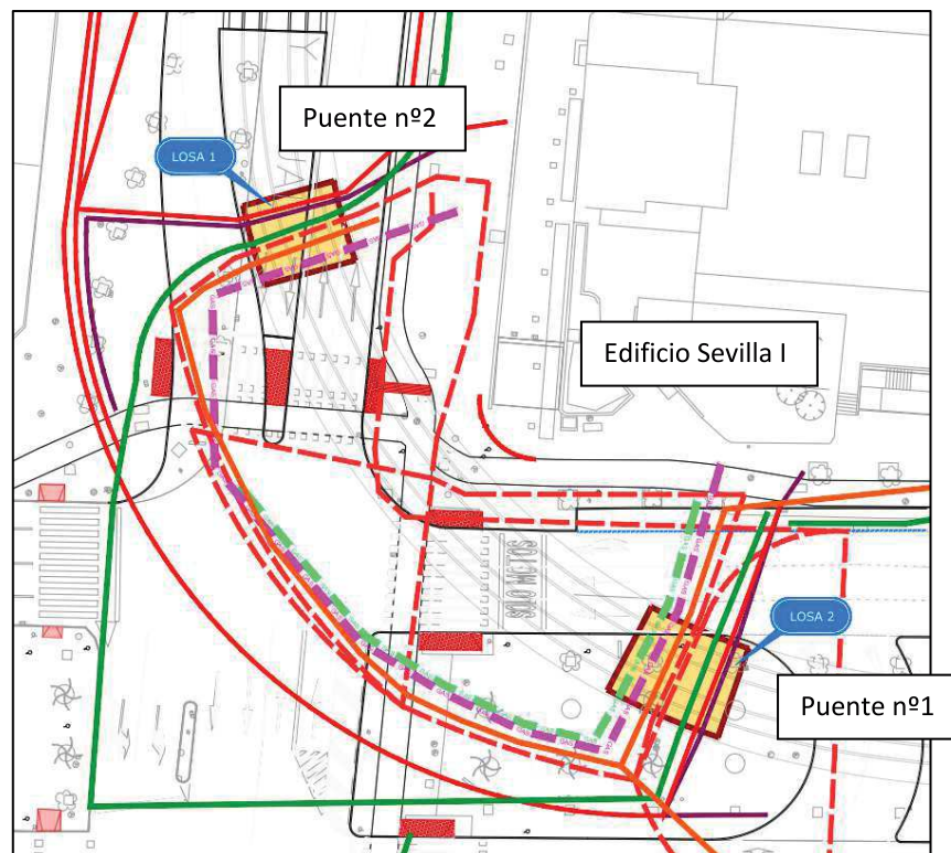
Servicios existentes a desviar según proyecto
